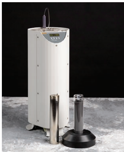
Mini cells realize faster inside a 9260 Mini Fixed-Point Furnace.
