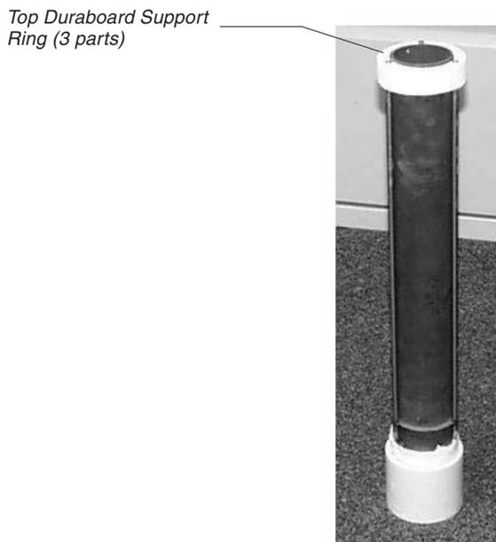
**Figure 1** *Central Heater Liner Assembly*
