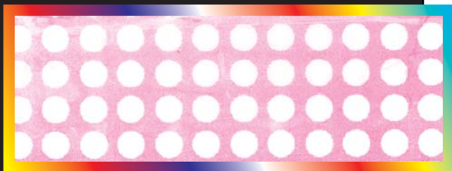
VÄRMEFÖRSEGLING. Ojämheter och icke kontakt
